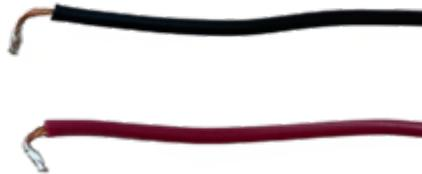
5. Schneide 2x 1,5 cm Schrumpfschlauch ab und ziehe je ein Stück Schrumpfschlauch über die verzinnten Litzenenden.
