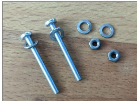
5. Schiebe die Schrauben mit den Sprengringen **von außen nach innen** durch die dafür vorgesehenen Löcher in der Motorhalterung und im Motor.
