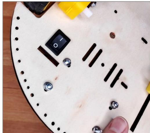
4. Stecke zwei Senkkopfschrauben **von oben nach unten** durch die Löcher der Batteriehalterung in der Mitte der Bodenplatte. Fixiere die Schrauben mit 2 Sprengringen und Muttern an der Unterseite der Bodenplatte und ziehe die Schrauben gut fest.
