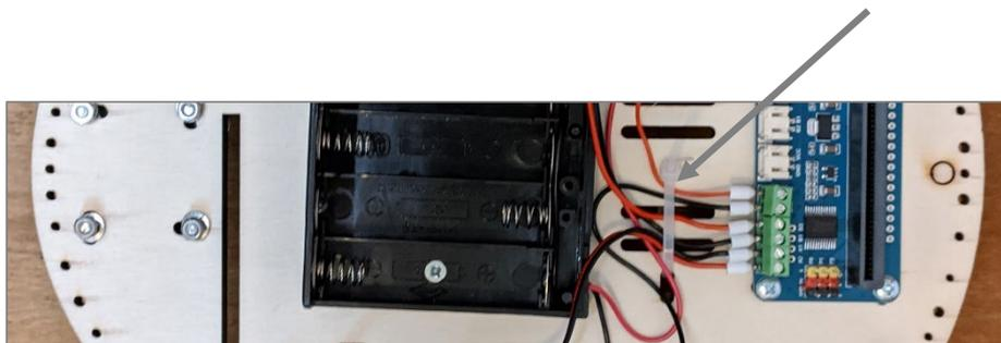
15. Stecke den Micro:bit (optional mit Schutzhülle) in das Motorboard ein. Die LEDs müssen nach vorne zeigen!
