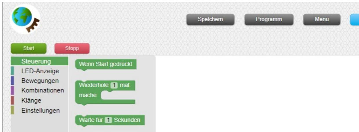
Im nächsten Schritt wird ein Testprogramm erstellt und gespeichert. Um die Funktionen der Robo4earth zu testen, sollte von jeder Kategorie (außer Einstellungen und Kombinationen) mindestens ein Block ausgewählt werden und in den Arbeitsbereich gezogen werden. Das Programm beginnt mit einem *Wenn Start gedrückt* Block. Ein Testprogramm, um alle Funktionalitäten der Robo4earth zu überprüfen, könnte zum Beispiel so aussehen:
