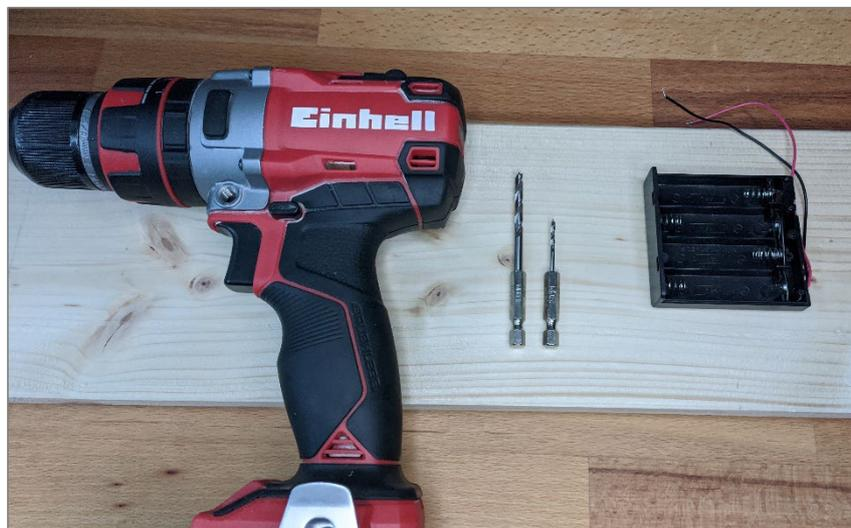
1. Bohre je ein Loch mit 4mm Durchmesser in die Mitte der beiden äußeren Batterie-Halterungen. **TIPP:** Wenn ein kleinerer Bohrer (2mm) vorhanden ist, bohre zuerst die Löcher mit dem kleineren Bohrer vor, damit keine Risse im Plastik entstehen und das Batteriefach beim Bohren nicht wegrutscht.
